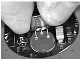
Figura 2. Installazione del sensore
