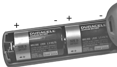
Figura 1. Batterie alcaline installate correttamente
