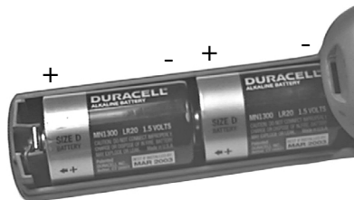
Figur 1. Rätt isatta alkaliska batterier
