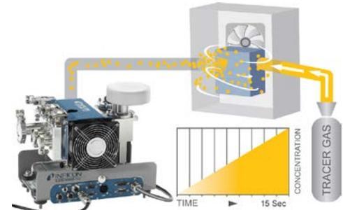
能够预先充注氦气的电池通常会通过真空舱室泄漏检测进行测试。此过程常用于测试圆柱形电池（18650 型）。
