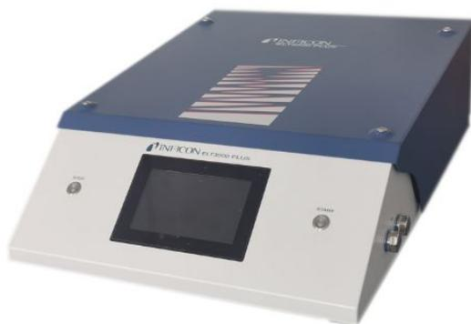
真空控制单元 (GCU) 集成了触摸屏，用于操作电池检漏仪。集成的泵用于将测试室抽到目标压力下的真空。适用于测量过程的阀门控制系统允许将分析气体送入气体检测系统。
