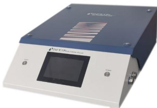
真空コントロールユニット（GCU）では、組み込まれているタッチディスプレイによりバッテリーリークディテクターの操作が可能です。内蔵ポンプは、テストチャンバーを希望の目標圧力まで真空排気するのに使用します。測定プロセスに適合化されたバルブ制御により、分析ガスがガス検出システムへ送られます。
