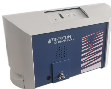
ガス検出システムは高真空により作動するので、四重極型質量分析計の圧力は常に $5 \times 10^{-4}$  mbar以下でなければなりません。この真空は、ダイアフラムポンプのサポートを得てターボ分子ポンプにより生成されます。
