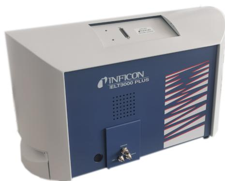
Il sistema di rilevamento del gas lavora sotto alto vuoto, cioè la pressione nello spettrometro di massa quadripolare deve essere sempre inferiore a  $5 \times 10^{-4}$  mbar. Questo vuoto si ottiene tramite la pompa turbomolecolare con il supporto di una pompa a membrana.
