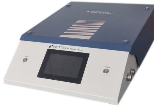
L'unità di controllo del vuoto (GCU) consente il funzionamento del tester di tenuta della batteria con il display touchscreen integrato. La pompa integrata viene utilizzata per l'evacuazione della camera di prova di misurazione alla pressione target desiderata. Un controllo valvola adattato alla sequenza di misurazione consente di alimentare il gas da analizzare al sistema di rilevamento dei gas.
