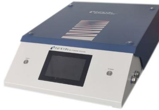
La unidad de control de vacío (GCU) permite el manejo del detector de fugas de batería con la pantalla táctil integrada. La bomba integrada se utiliza para evacuar la cámara de prueba de medición hasta la presión objetivo deseada. Un control de válvula adaptado a la secuencia de medición permite alimentar el gas de análisis al sistema de detección de gas.
