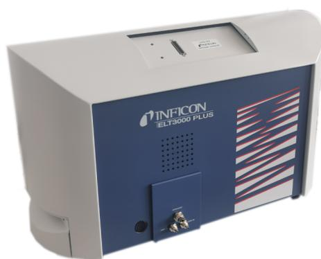
El sistema de detección de gas trabaja en condiciones de alto vacío, por lo que la presión en el espectrómetro de masas cuadrupolar tiene que ser siempre menor de  $5 \times 10^{-4}$  mbar. Este vacío es generado por la bomba turbomolecular con el apoyo de una bomba de membrana.
