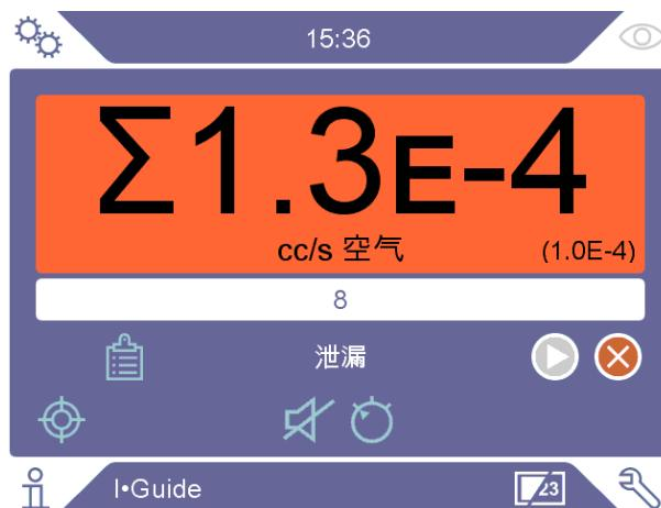
执行了一次测量后，按下“结果列表”图标即可打开显示所有测量值的表格。
