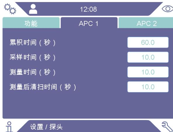
可以在“设置>探头>APC 2”菜单中设置清洗触发级别，以保护传感器暴露于大量示踪气体中。
