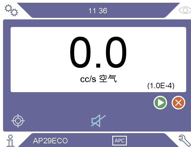
激活“设置>探头>APC 2”菜单中的“连续测量”复选框将停用测量时间参数。通过按下操作屏幕上的“开始”和“停止”按钮或发送“开始”和“停止”命令来控制测量时间。
