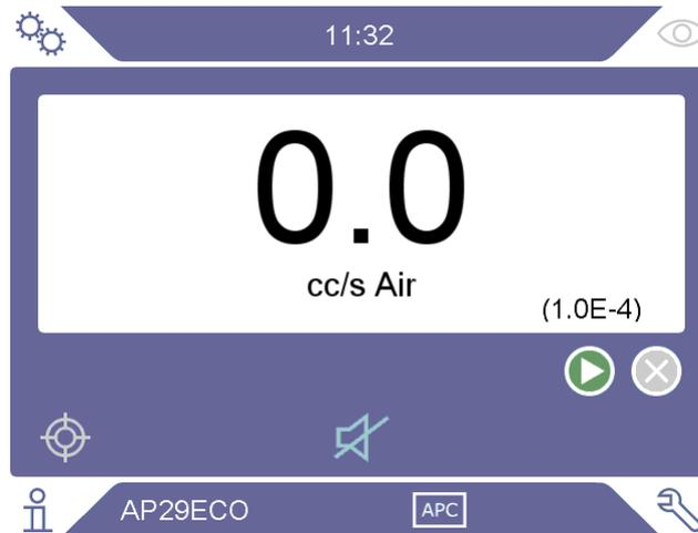
L'activation de la case à cocher Mesure continue dans le menu « Réglages > Sonde > APC 2 » permet de désactiver le paramètre Durée de mesure. L'utilisateur peut alors déterminer la durée de la mesure en appuyant sur les boutons Start et Stop de l'écran de fonctionnement ou en envoyant les commandes Start et Stop.
