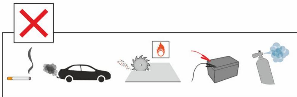
Evite colocar el equipo cerca de fuentes de hidrógeno, como p. ej. humo de cigarrillo, motores de combustión, máquinas para el procesamiento de aluminio, estaciones de carga para baterías de plomo y, en algunos casos, también sistemas de aire comprimido.
