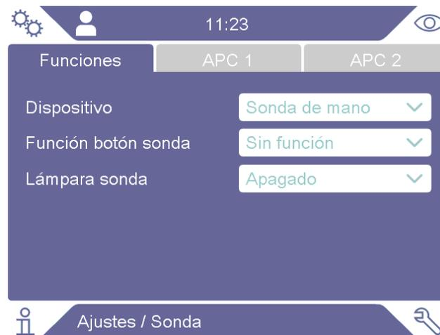
En este modo se desactivan las pestañas APC 1 y APC 2, que se utilizan para el control del accesorio AP29ECO.
