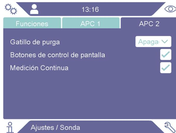
El nivel de activación de la purga puede ajustarse al nivel de alarma o a un factor del mismo. Los factores que pueden elegirse son 1,5x, 2x, 5x o 10x del nivel de alarma.
