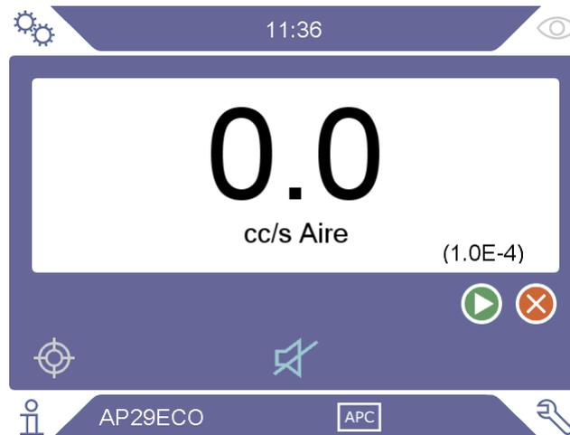
La activación de la casilla «Medición continua» en el menú «Configuración > Sonda > APC 2» desactiva el parámetro «Tiempo de medición». Por el contrario, el tiempo de medición se controla pulsando los botones de Inicio y Parada en la pantalla de funcionamiento o enviando comandos de inicio y parada.
