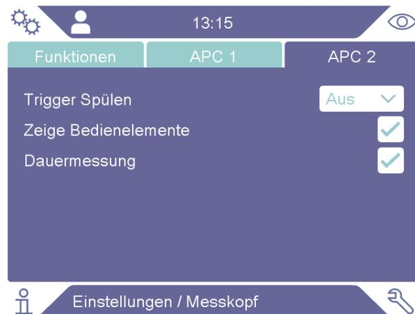
Die Spülauslösungsstufe kann auf den Alarmpegel oder einen Faktor dessen eingestellt werden. Die auswählbaren Faktoren sind 1,5x, 2x, 5x oder 10x Alarmpegel. Wenn das Kontrollkästchen "Steuertasten anzeigen" im Menü "Einstellungen > Handmesskopf > APC 2" aktiviert wird, werden die Start- und die Stopp-Taste zum Betriebsbildschirm hinzugefügt.
