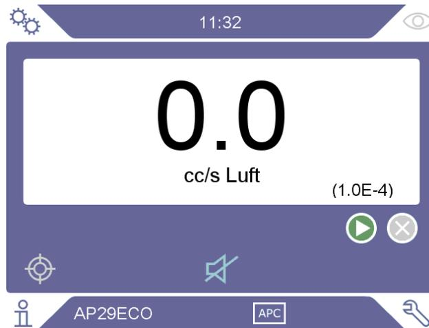
Wenn das Kontrollkästchen "Dauermessung" im Menü "Einstellungen > Handmesskopf > APC 2" aktiviert wird, wird der Messzeit-Parameter deaktiviert. Die Messzeit wird stattdessen durch einen Druck auf die Start- und Stopp-Tasten auf dem Betriebsbildschirm oder durch den Versand von Start- und Stopp-Befehlen gesteuert.
