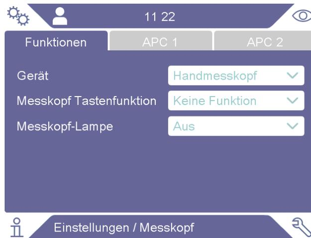
Die Registerkarten "APC 1" und "APC 2", die für die Steuerung des AP29ECO-Zubehörs verwendet werden, sind in diesem Modus deaktiviert.
