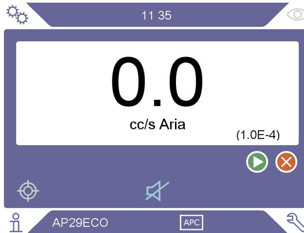
Attivando la casella di controllo della misurazione continua nel menu "Impostazioni > Sonda > APC 2" si disattiva il parametro Tempo misurazione. Il tempo della misurazione viene controllato premendo i pulsanti Start e Stop sulla schermata operativa o inviando un comando Start o Stop.
