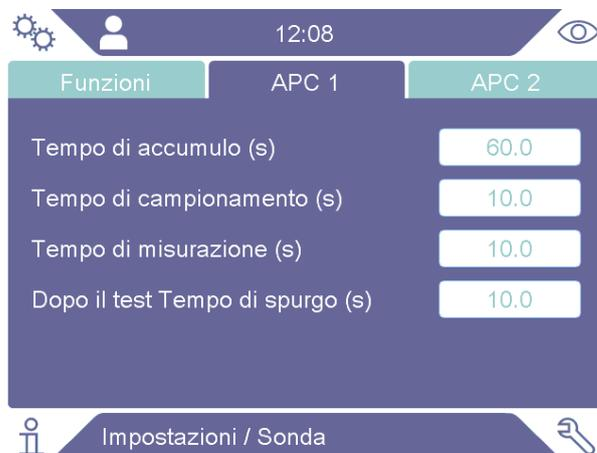
Un livello di trigger di spurgo può essere impostato nel menu "Impostazioni > Sonda > APC 2" per proteggere il sensore da esposizioni a gas di prova intense.
