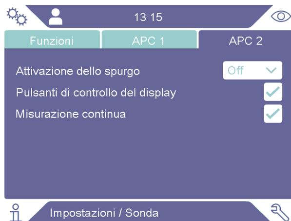
Il livello di trigger di spurgo può essere impostato sul livello di allarme o a un relativo fattore. I fattori selezionabili sono 1,5x, 2x, 5x, o 10x il livello di allarme.
