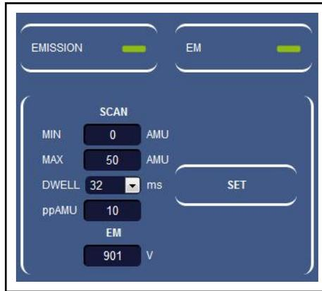
要打开/关闭发射，请单击 **EMISSION**。**EMISSION** 按钮的右侧有一个指示灯。该指示灯将根据发射状态改变颜色。如图 5-10 所示共有三种颜色。
