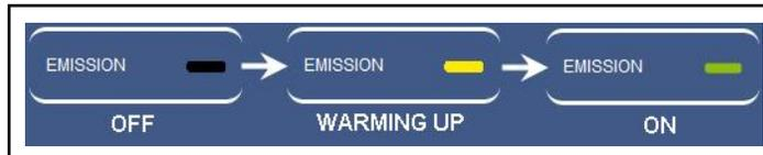
电子倍增器（EM）的控制方式与发射相同。要打开或关闭 EM，请单击 **EM**。这里只有两种不同的 EM 状态：**OFF**（黑色）和 **ON**（绿色）。参见图 5-11。
