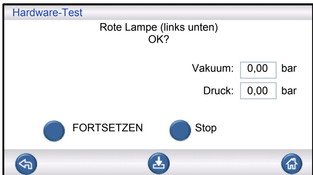
Dies ist eine "manuelle" Prüfung. Der ILS500 F/FHP schaltet eine Lampe nach der anderen ein. Überprüfen Sie einfach, ob die richtige Lampe aufleuchtet.
