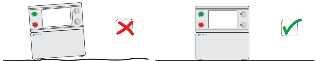
Platzieren Sie den ILS500 F/FHP auf einer ebenen Fläche, so nahe wie möglich an der Prüfvorrichtung und Entlüftungsanlage.
