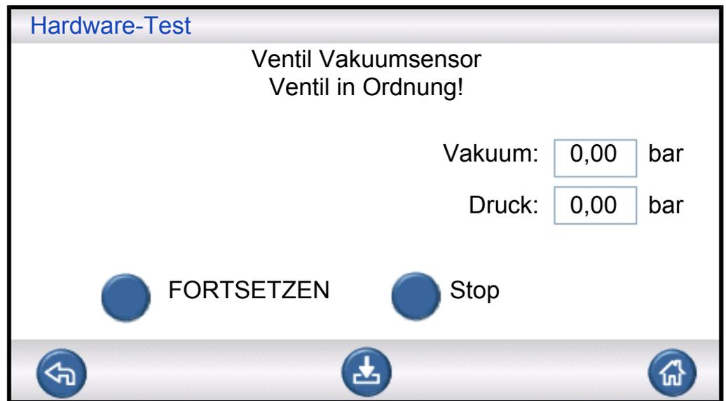
Hier wird überprüft, ob das Ventil schließt, um den Vakuumsensor vor dem Füllen zu schützen. Mögliche Ergebnisse:
