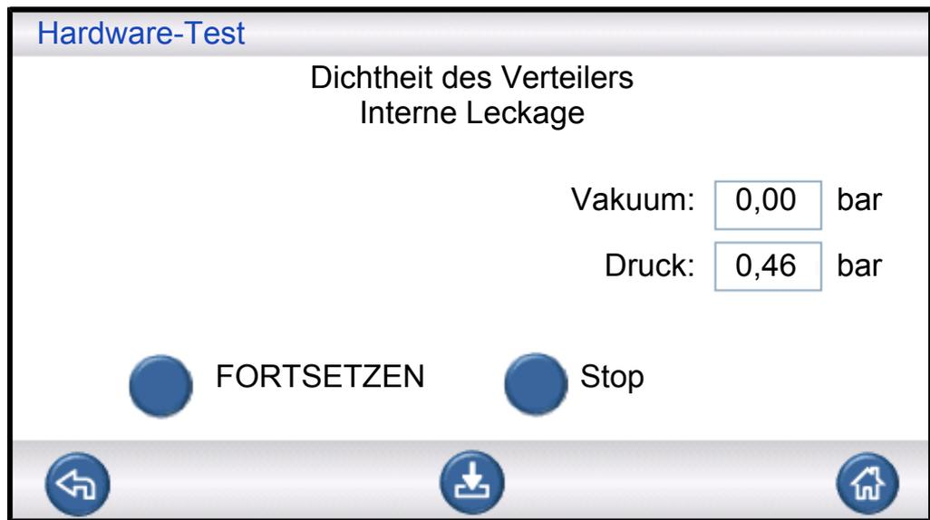
Die allgemeine Dichtheit des Verteilers wird anhand der Druckabfallmethode geprüft. Dies ist eine Ergänzung zum Gastest, um festzustellen, ob Lecks nach außen, in der Abgasleitung usw. vorhanden sind.
