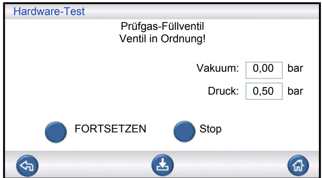
In diesem Schritt wird geprüft, ob das Prüfgas-Füllventil zum Befüllen mit Gas öffnet. Die Prüfung ist nicht bestanden, wenn der Zuleitungsdruck des Prüfgases zu niedrig ist. Wenn dies der Fall ist, passen Sie den Druck entsprechend an und starten Sie dann den Hardware-Test neu.
