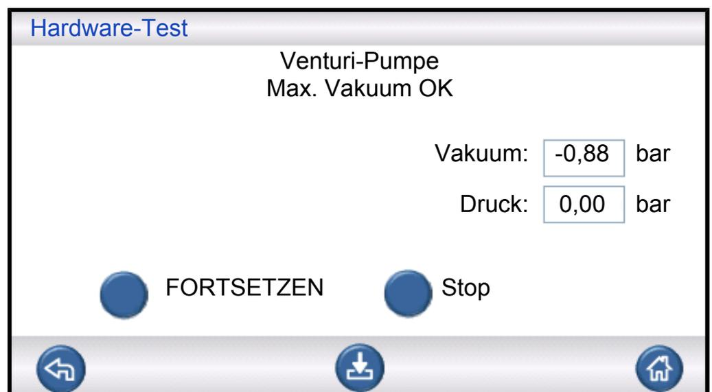
Das maximale Vakuum der Venturi-Pumpe wird geprüft. Mögliche Ergebnisse:
