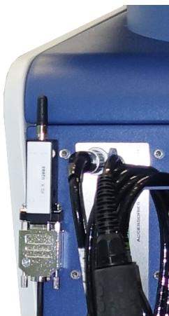
插图 22: 可以使用随附的胶带将发射机固定到一个可用位置。
