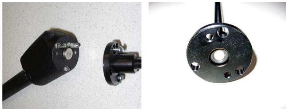
插图 20: 嗅探器手柄中的烧结过滤器
