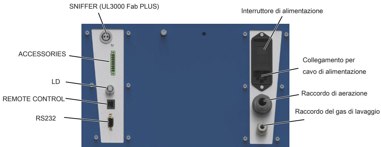
Fig. 6: Collegamenti per accessori e segnali di controllo
