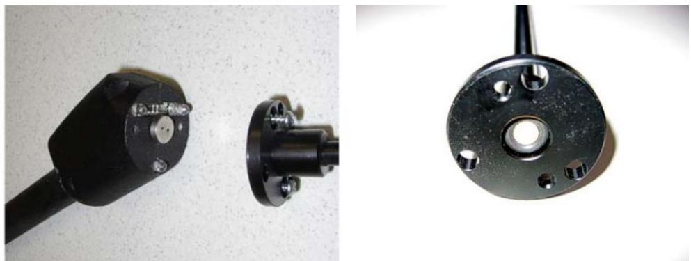
Fig. 20: Filtro di sinterizzazione nell'impugnatura sniffer
