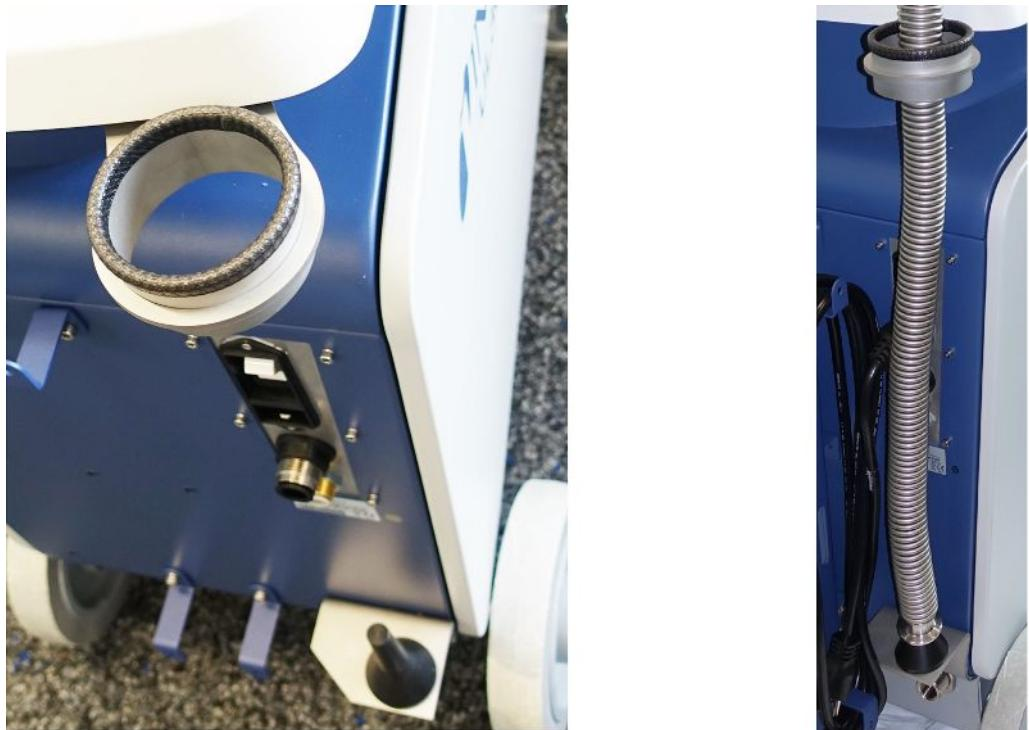
Fig. 9: Il supporto per tubo corrugato è installato.
