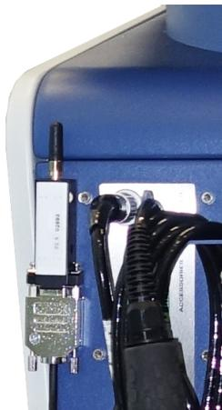
Fig. 22: Il trasmettitore può essere fissato in un posto libero con il velcro in dotazione.
