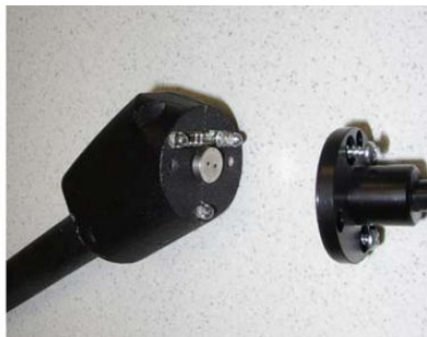
插图 19: 嗅探器手柄中的烧结过滤器
