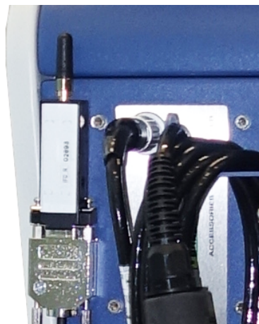
図 21: マジックテープを使用してトランスミッターを空いた場所に固定
