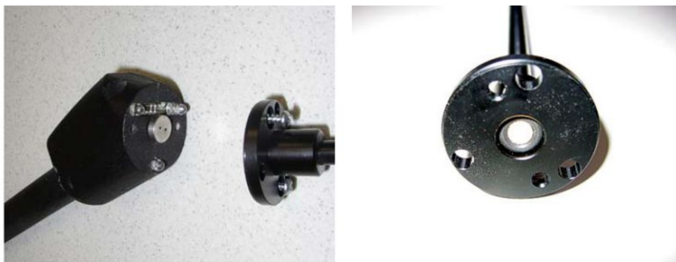
図 19: スニファーハンドル内の焼結フィルター
