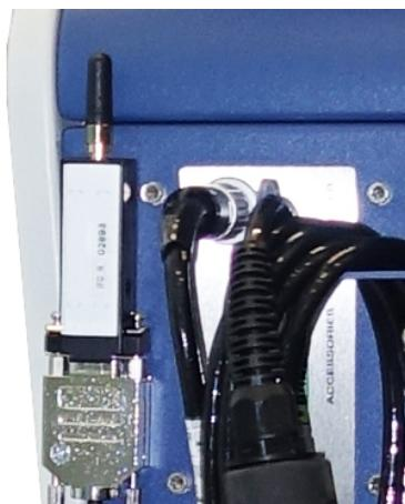
図20:マジックテープを使用してトランスマッターを空いた場所に固定
