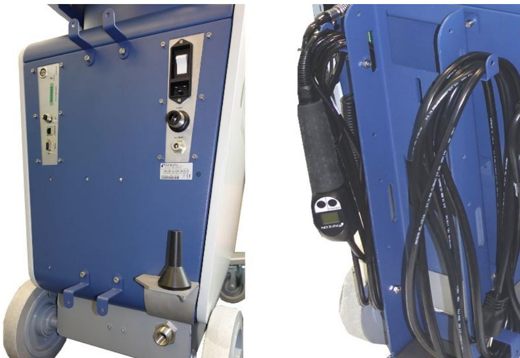
Рис. 8: Крюк на приборе или дополнительном держателе баллонов
