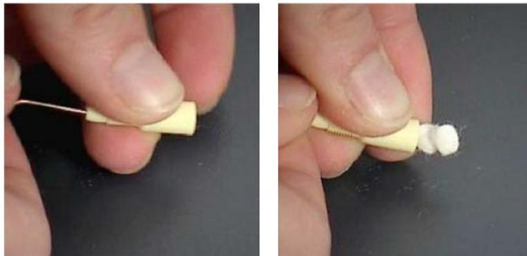
Рис. 17: Выдавите патроны из капиллярного фильтра
