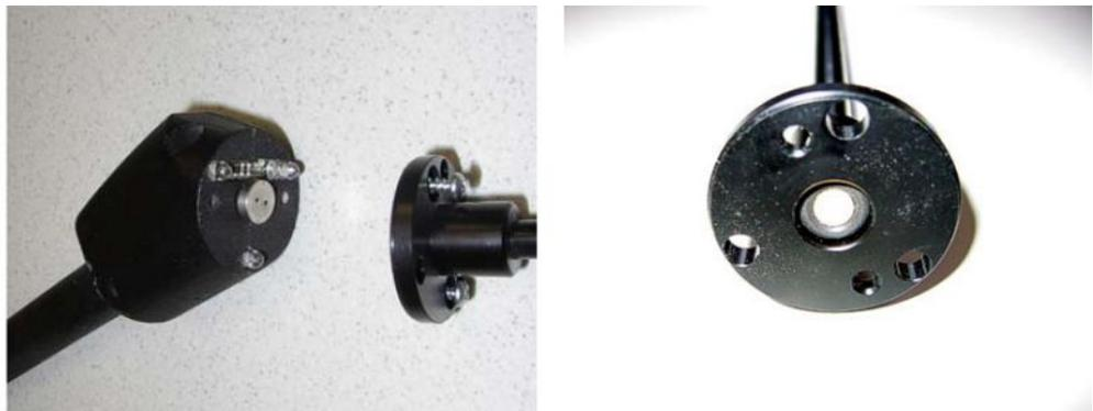
Fig. 19: Filtro di sinterizzazione nell'impugnatura sniffer
