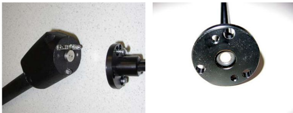
Rys. 19: Filtr spiekany w uchwycie sondy zasysającej
