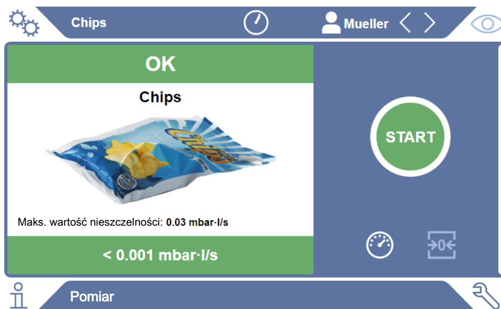
Rys. 1: Wskazanie pomiaru na zielonym tle oznacza brak zastrzeżeń względem obiektu próbnego.
