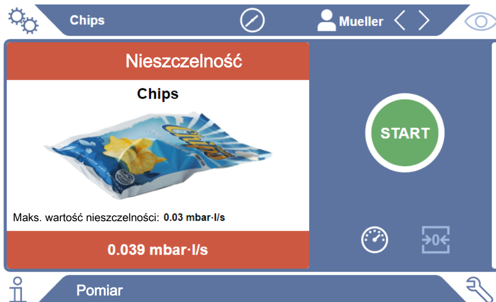
Rys. 2: Wskazanie pomiaru na czerwonym tle oznacza zbyt wysoką wartość nieszczelności.
