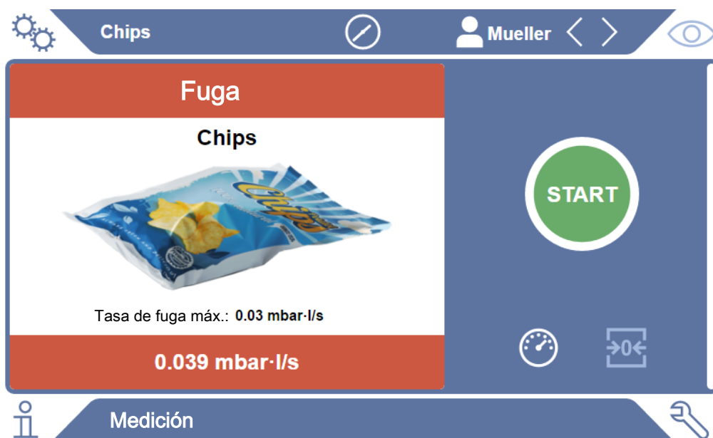
Fig. 2: Visualización de la medición sobre rojo si la tasa de fuga es demasiado elevada
