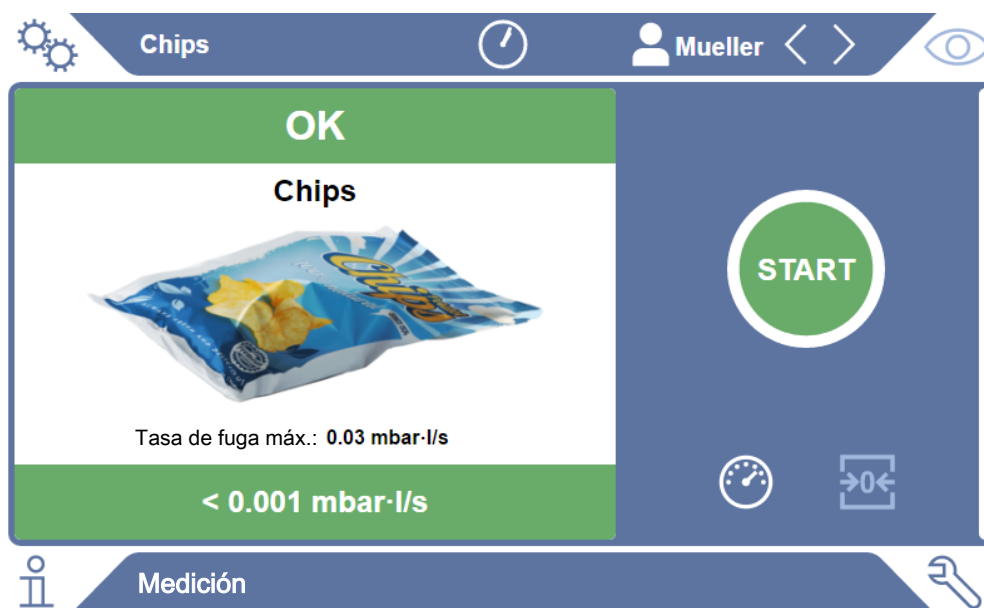
Fig. 1: Visualización de la medición sobre verde si el objeto de ensayo no presenta problemas
