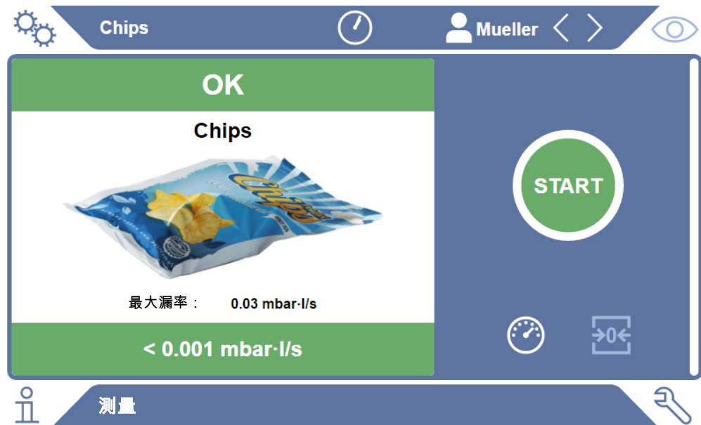
插图 1: 以绿色背景显示的测量结果，对应于无缺陷的测试对象
