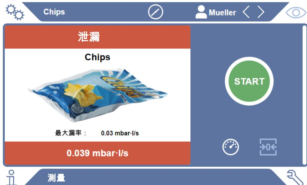
插图 2: 以红色背景显示的测量结果，对应于高漏率
