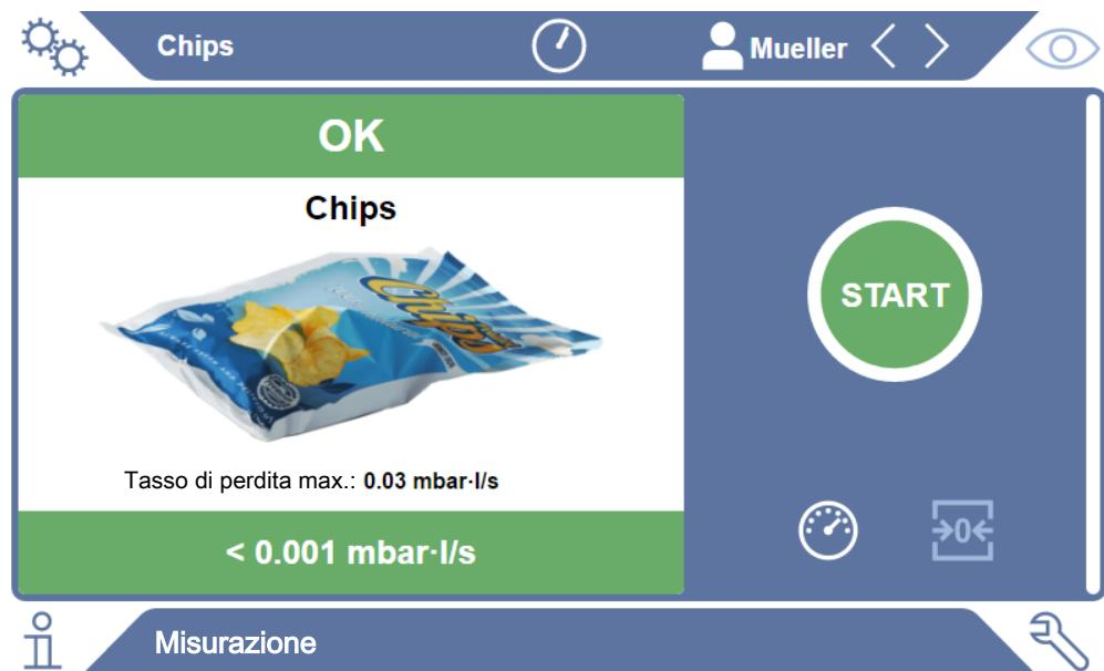
Fig. 1: Indicatore di misura su sfondo verde con oggetto di prova senza anomalie
