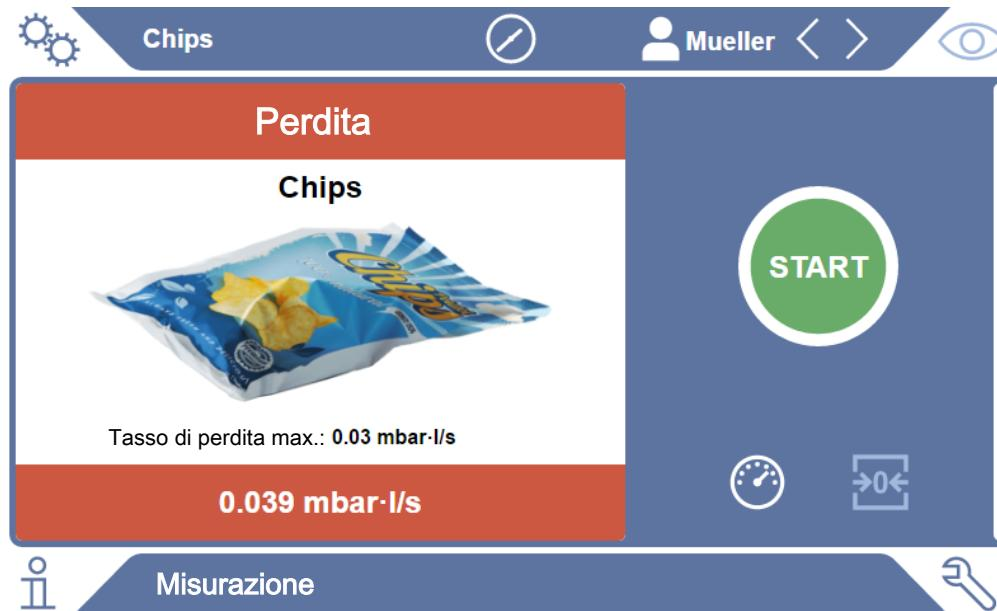
Fig. 2: Indicatore di misura su sfondo rosso con tasso di perdita troppo elevato
