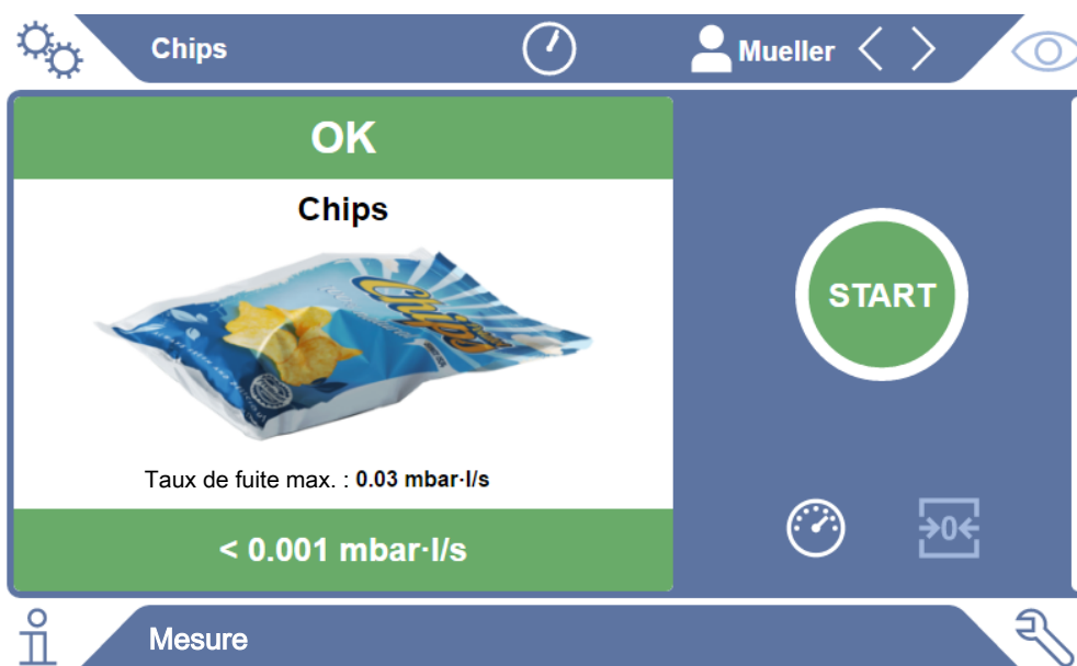
Fig. 1: Résultat de mesure sur fond vert pour un échantillon sans défaut
