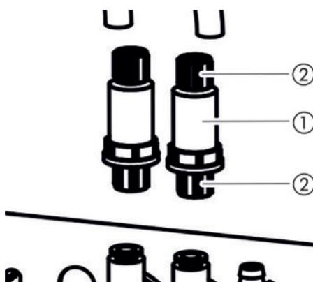
Fig. 6: Éléments filtrants à l'arrière de l'appareil
