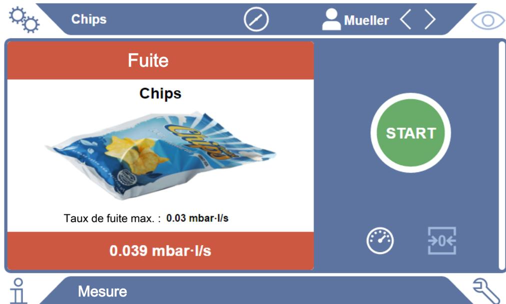
Fig. 4: Résultat de mesure sur fond rouge en raison d'un taux de fuite excessif
