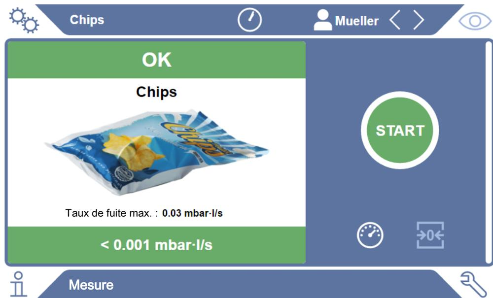
Fig. 3: Résultat de mesure sur fond vert pour un échantillon sans défaut
