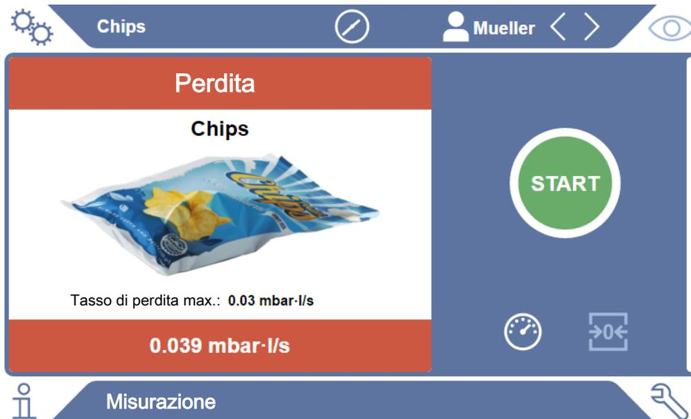
Fig. 4: Indicatore di misura su sfondo rosso con tasso di perdita troppo elevato
