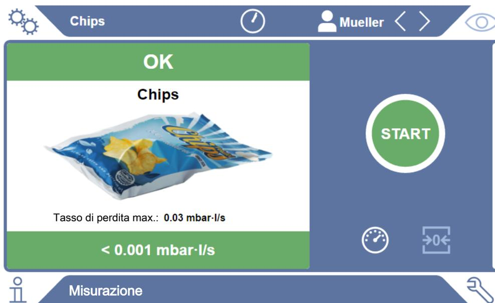
Fig. 3: Indicatore di misura su sfondo verde con oggetto di prova senza anomalie
