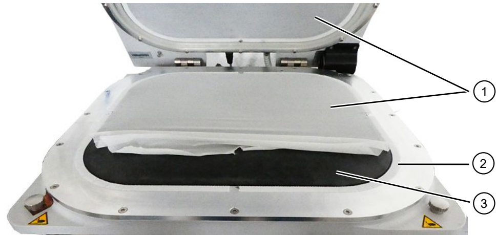
Fig. 5: Destensado de la malla
