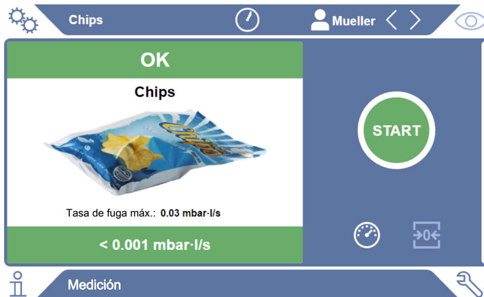
Fig. 3: Visualización de la medición sobre verde si el objeto de ensayo no presenta problemas
