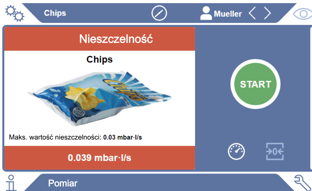
Rys. 4: Wskazanie pomiaru na czerwonym tle oznacza zbyt wysoką wartość nieszczelności.
