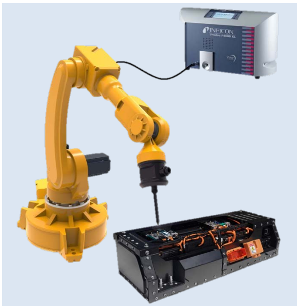
Fig.2: Prinzip der statischen Prüfung
