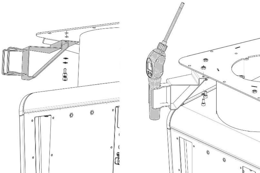
1 请按照图中所示, 借助两个螺栓和垫片将支架安装在设备的背面。
