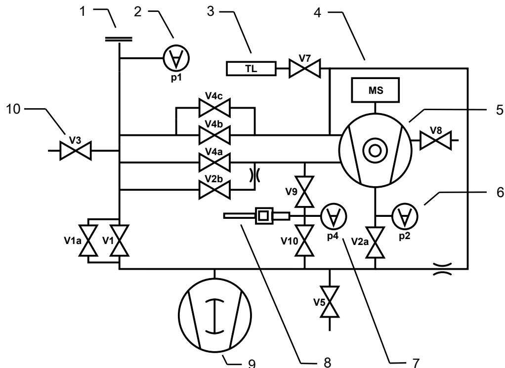
插图 14: UL3000 Fab ULTRA 设备中真空图的最重要的成分
