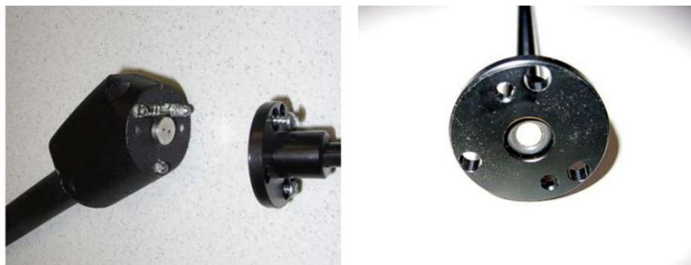
插图 19: 嗅探器手柄中的烧结过滤器
