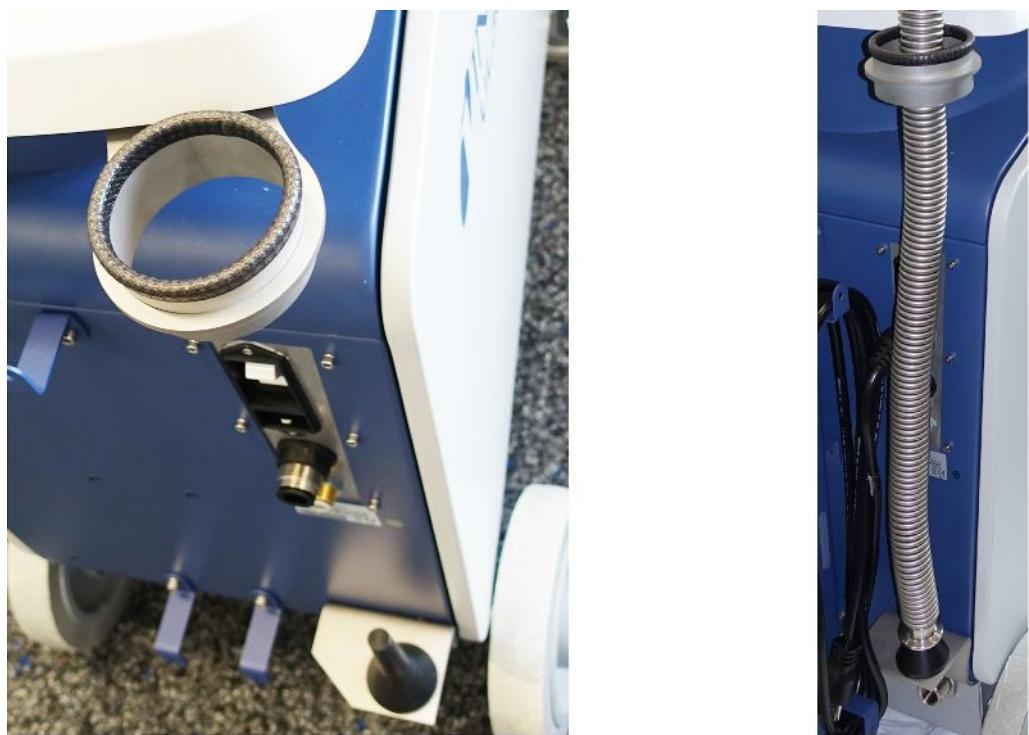
插图 9: 已安装波纹管固定架。
