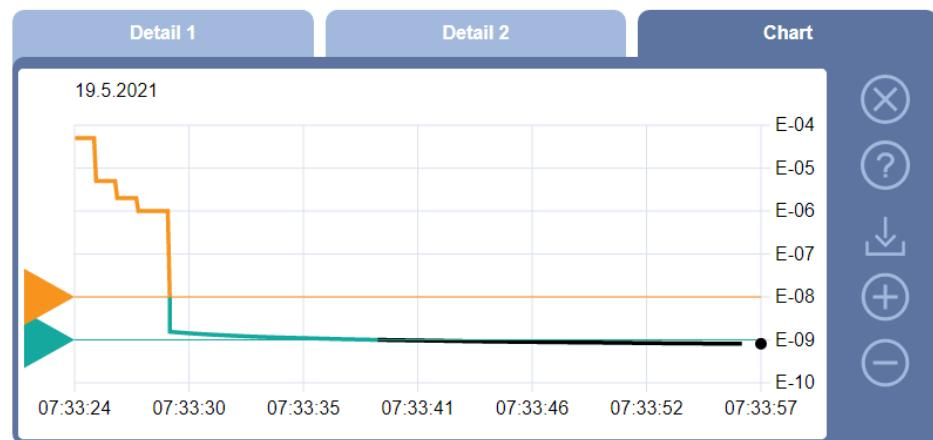
**5** 为了导出显示的周期，将U盘(FAT32格式化)连接到检漏仪并按下 $\downarrow$ 。
