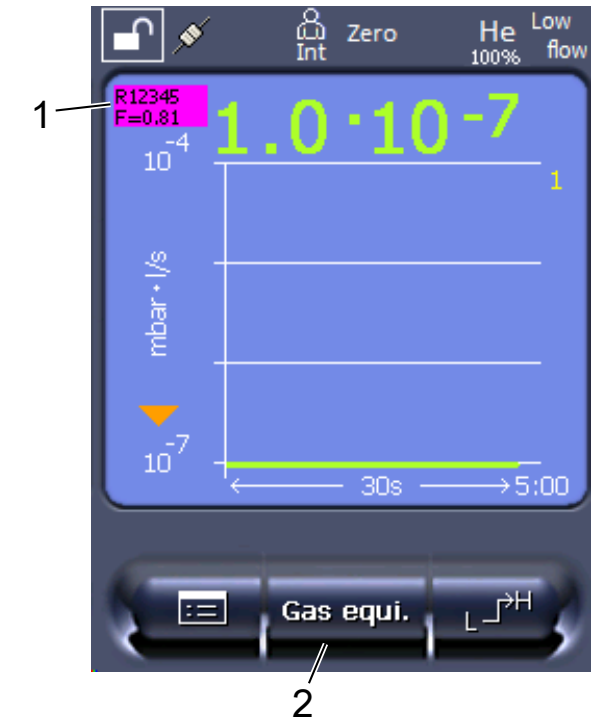
插图 14: 测量界面上显示等效漏率并设有收藏夹键
