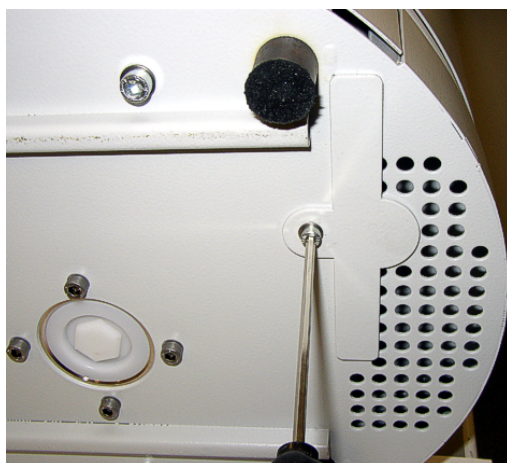
插图 46: 松开空滤器护板
