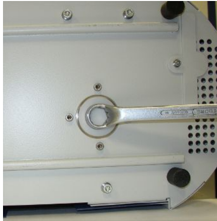
插图 47: 锁闭工作材料存储器
