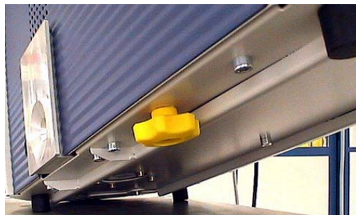
插图 5: 起动前，拧出黄色的运输保险装置
