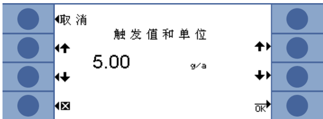
插图 22: 设置触发器值和单位
