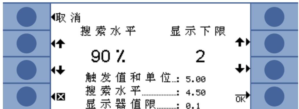
插图 23: 设置显示极限和查找阈
