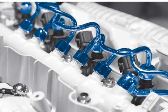
为了降低燃料消耗，人们开始越来越多地使用高压燃料喷射技术。喷射压力在过去几年内得到了大幅提高。现在喷射压力可高达 2000 bar（大约 150000 psi）。燃料泄漏不仅会增加燃料消耗，还有可能在发动机室内引发火情。随着燃料喷射压力的增加，即使泄漏孔截面相同，泄漏率也会增大。
