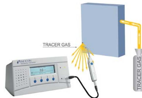
对于大型电池包或手动检测而言，建议使用 [Sensistor Sentrac](#) 氢气检漏仪对合成气体进行吸枪检漏。
