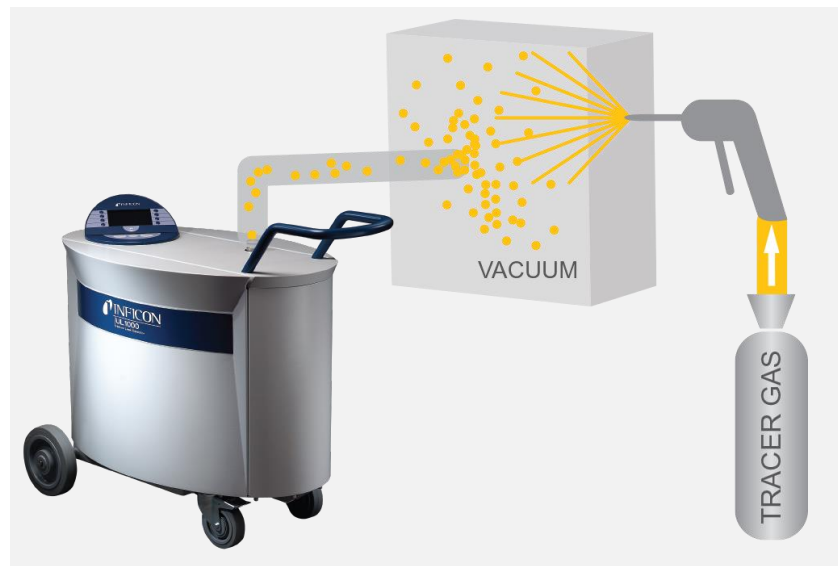
喷氮泄漏检测
