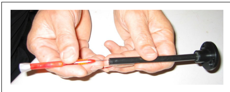
図 80 金属キャピラリーの押し出し
