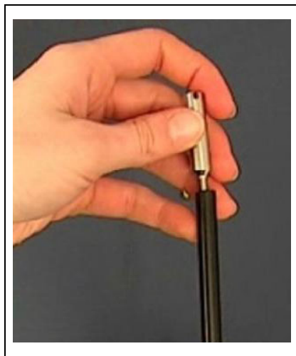
図3 防水チップの取り付け
