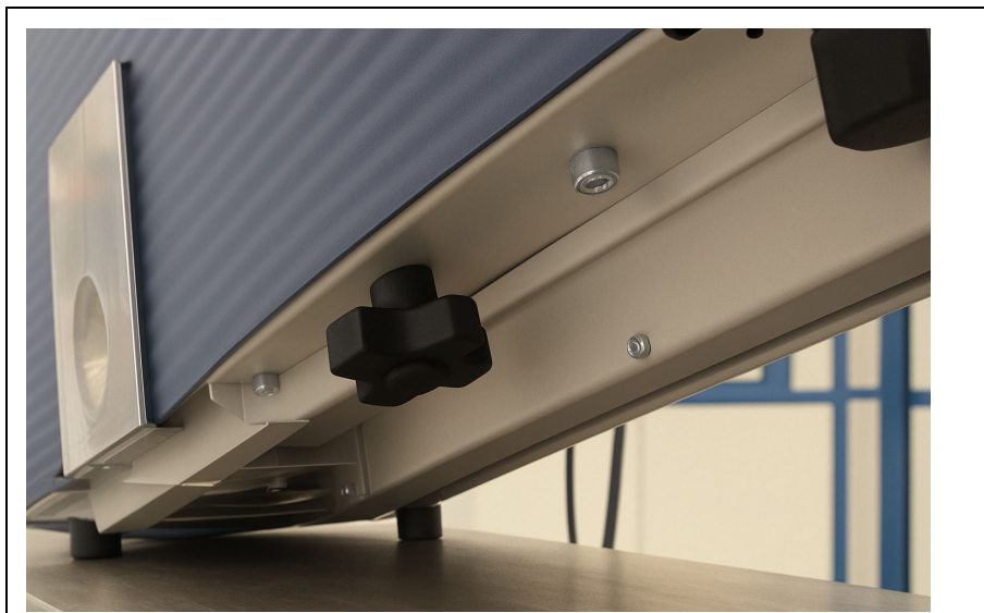
図 2 起動前の搬送用ロックの取り外し
