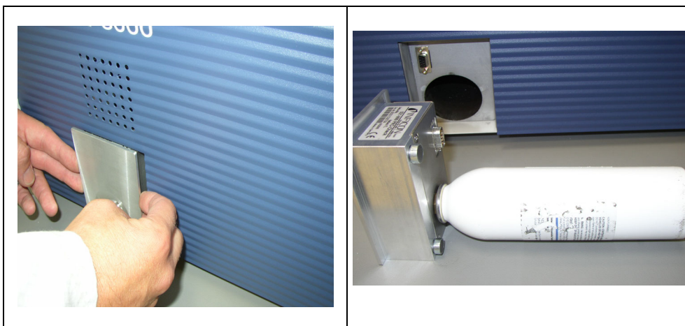
図 82 内部校正器 PRO-Check の本体ユニットからの取り外し
