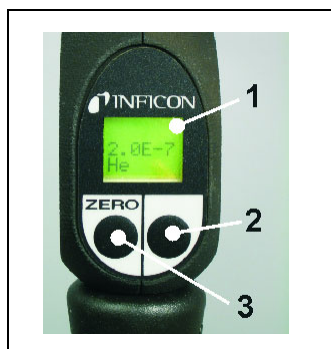
図 11 プローブディスプレイ付きスニファーライン SL3000 (XL)
