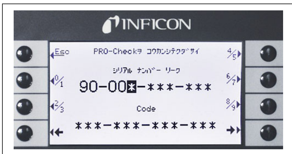
図 4 内部校正器 PRO-Check 初期設定
