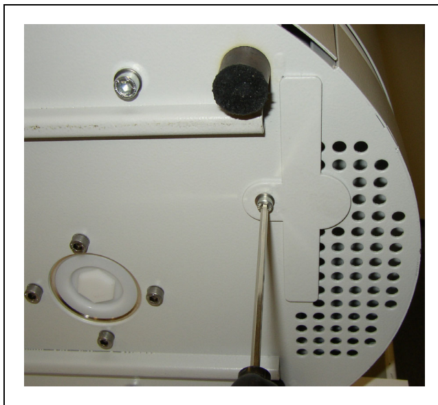
図 69 Protec P3000 底部にエアフィルタの固定ネジ
