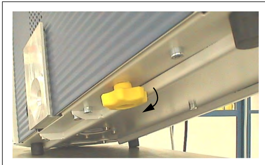
図 3 起動前の搬送用ロックの取り外し
