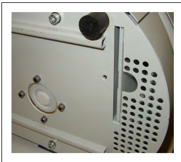
図 71 エアフィルタの取り外し
