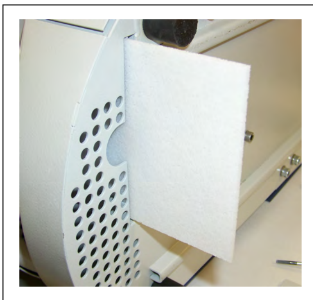
図 72 エアフィルタの挿入
