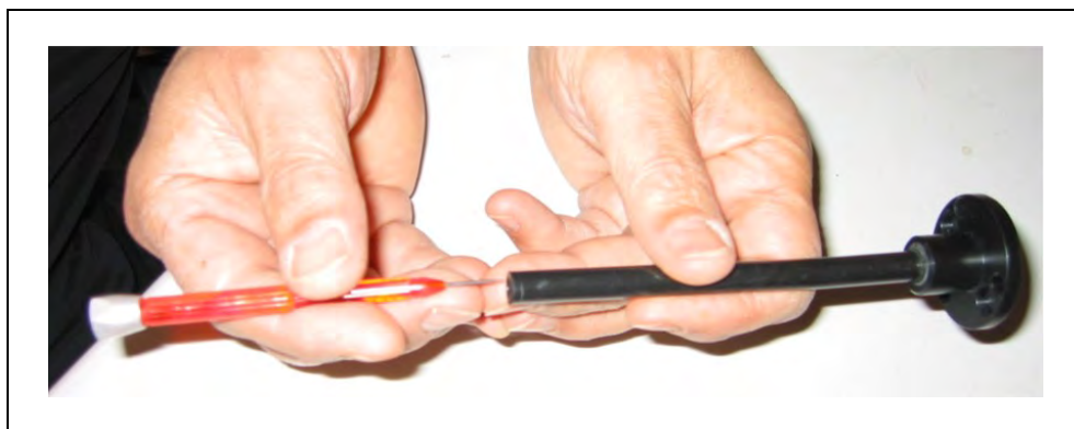
図 82 金属キャピラリーの押し出し
