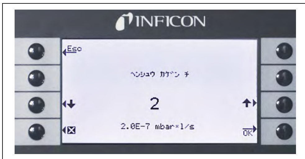
図 48 「Display limit (ヒョウジハンイ：表示下限)」の編集
