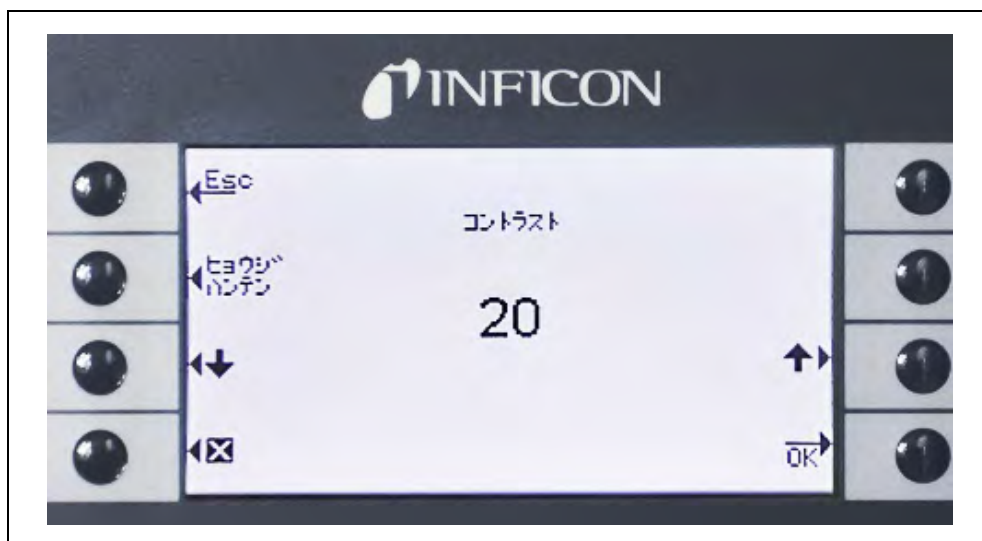
図 55 本体ディスプレイの「Contrast (コントラスト)」のセットアップ
