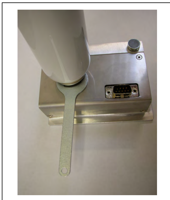
図 86 ガスリザーバの設置
