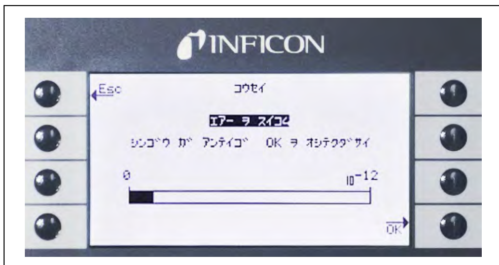
図 37 外部校正中の「Sniff air! (エアーヲスイコム：空気を吸入)」リクエスト
