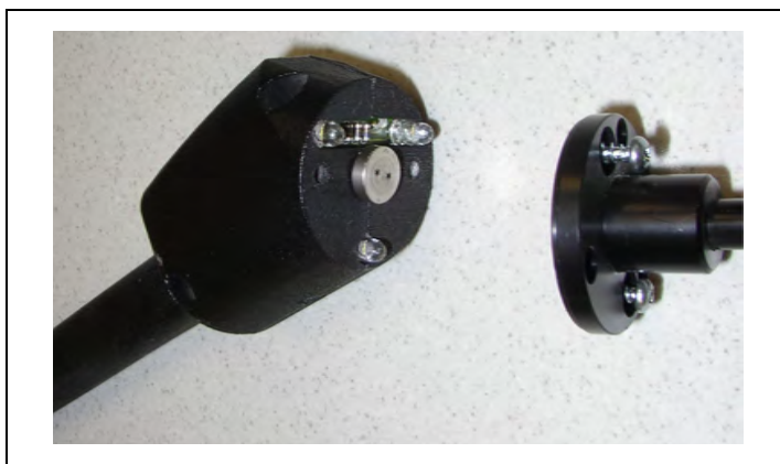
図 77 スニファーチップの取り外し
