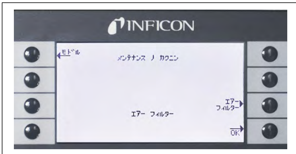
図 65 メンテナンス作業の確認
