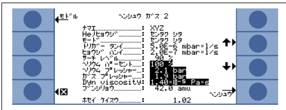
図 45 ユーザーガスの冷媒補正係数の設定
