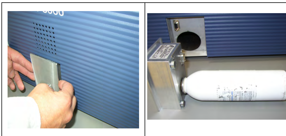
図 84 内部校正器 PRO-Check の本体ユニットからの取り外し
