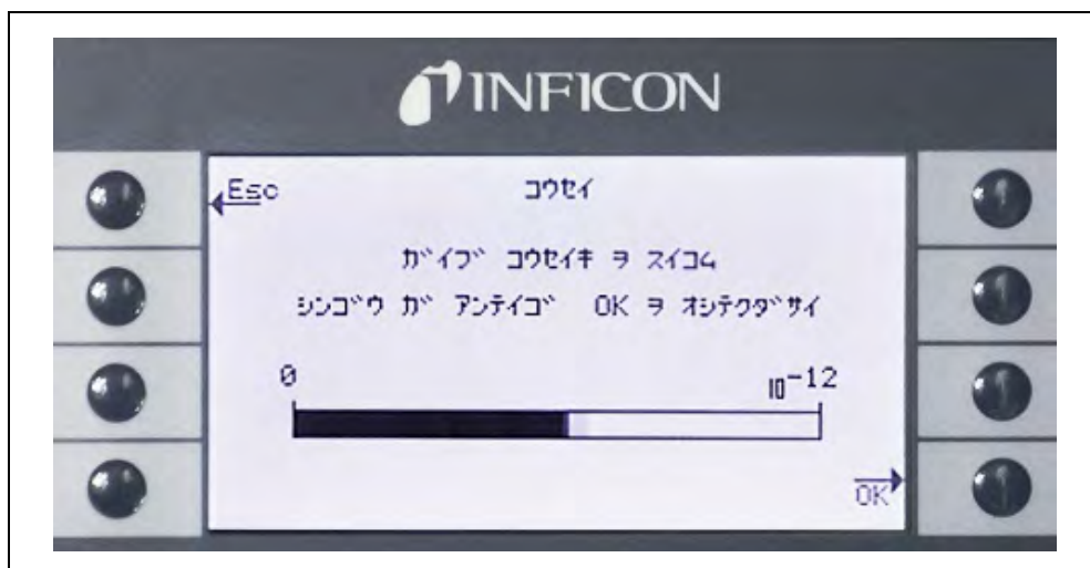
図 36 外部校正中の校正画面
