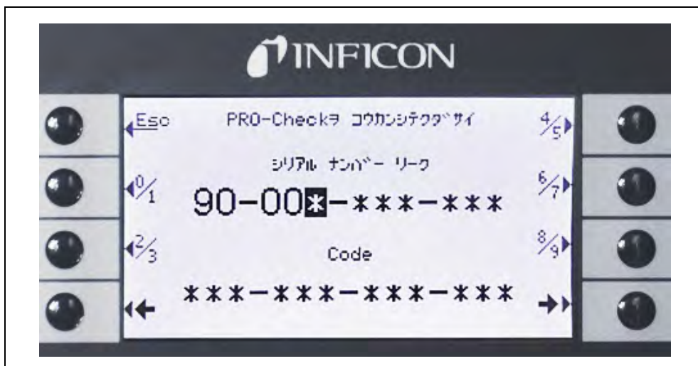
図 66 新しい PRO-Check ガスリザーバの有効化
