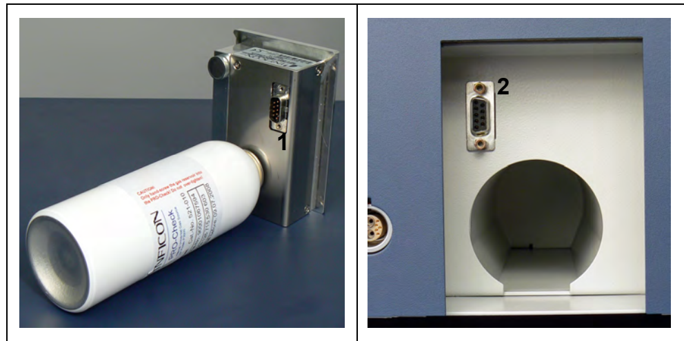
図 16 リモートで使用するための接続
