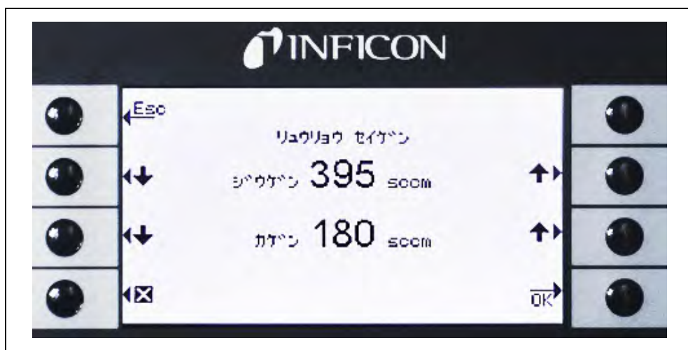
図 50 スニファールライン SL3000 の流量限界の設定
