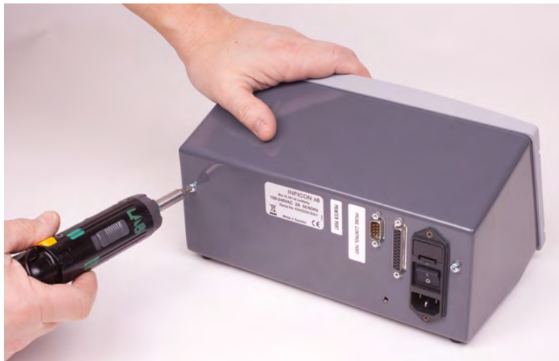
図 E-7: 2 本のトルクスネジを取り外す
