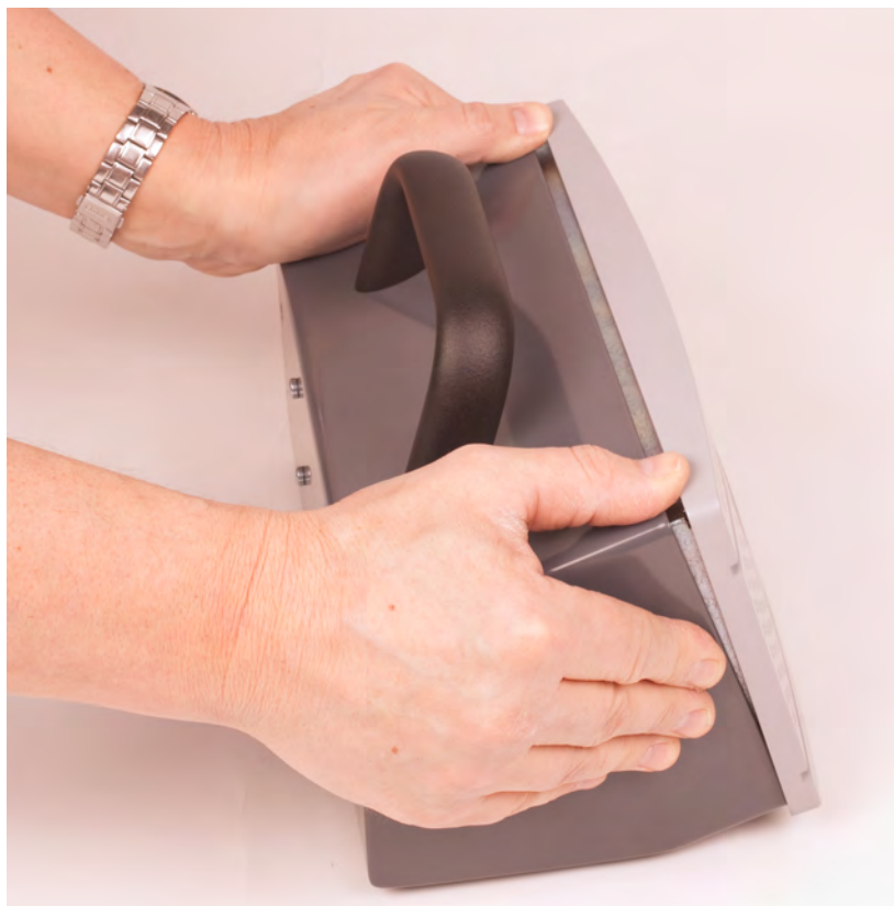
図 E-11: フロントカバーを押し出す
