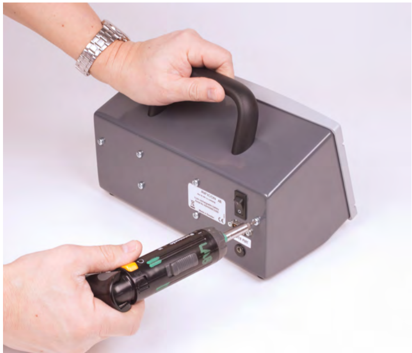
図 E-10: 機器の電源を切り、分解作業を始める
