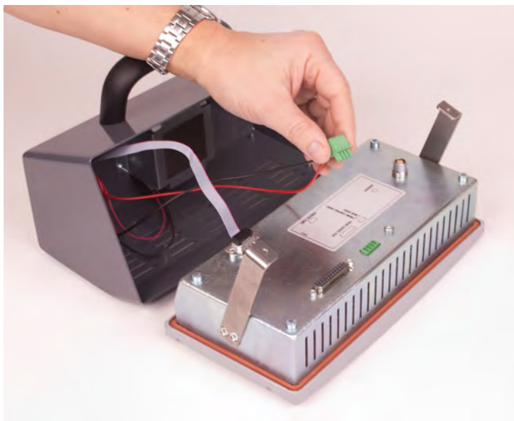
図 E-12: フロントカバーを押し出す
