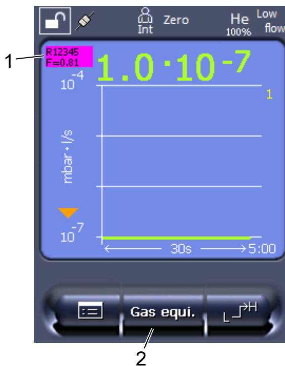
図3: 等価リークレートの表示とセットアップされたお気に入りボタンのある設定画面
