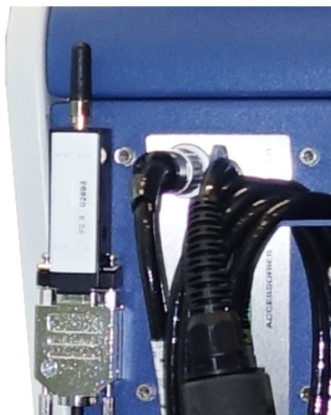
図 21: マジックテープを使用してトランスミッターを空いた場所に固定
