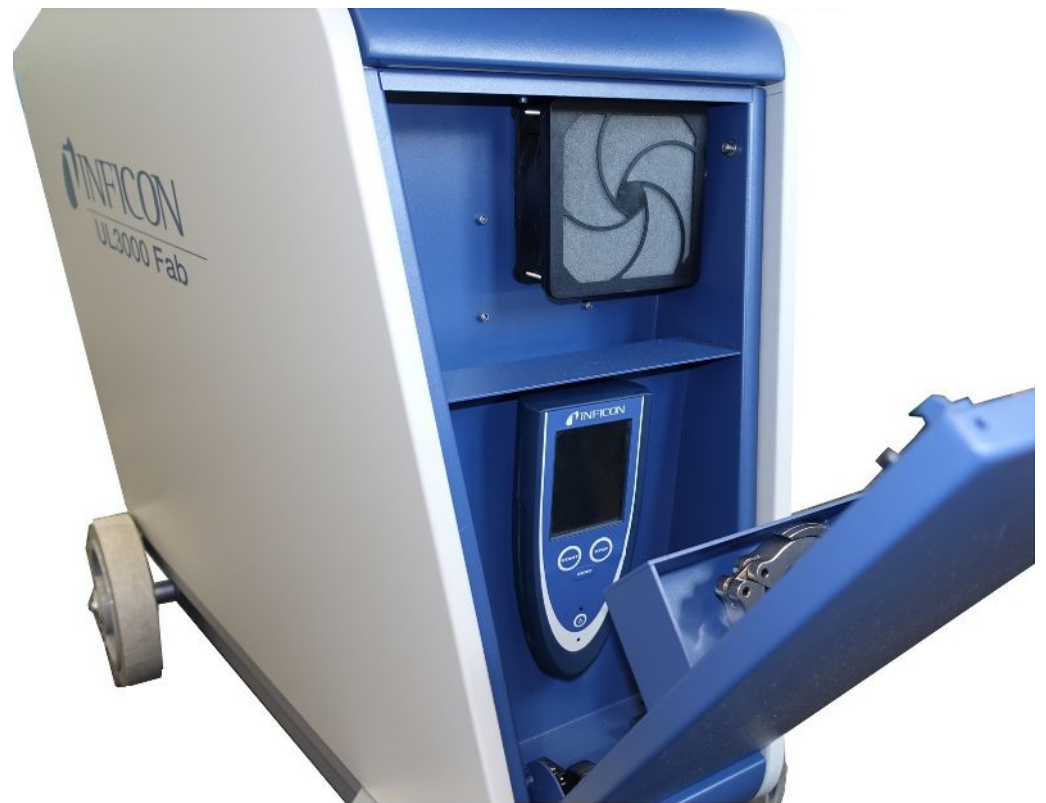
図 2: フラップを開けた正面図。図に示したリモートコントローラ RC1000 はオプションです。
