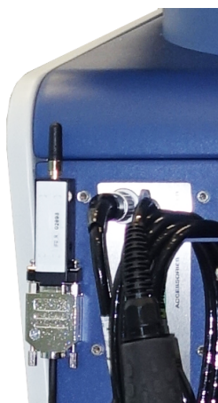
図 22: 付属の面ファスナーを使用して固定した送信装置。
