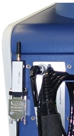
図 22: 送信機は、付属のベルクロテープでフリースポットに取り付けることができます。
