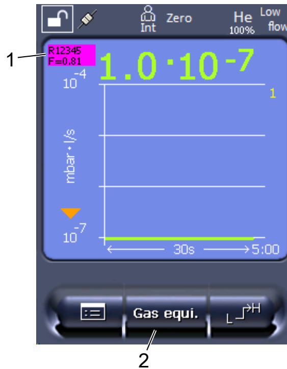
図 23: 等価リークレートの表示とセットアップされたお気に入りボタンのある設定画面
