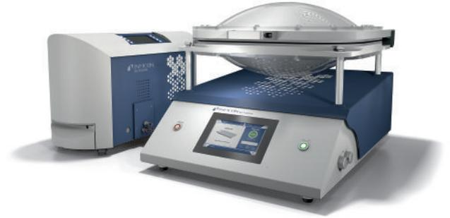
INFICON ELT3000を使用してユニークなバッテリーセル検査システムを構築することにより、ISO 9000規格への適合に役立てることができます。このシステムは、リークを（圧力変化などの）パラメータにより間接的にではなく、直接に検知する唯一のものです。質量分析計の技術をベースにしたこのシステムは、従来の加圧法の1,000 倍の精度でリークを検出できます。新しい ELT3000 は、最大 10 年間のバッテリー寿命保証を可能にします。
