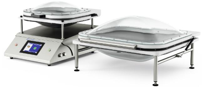
テストチャンバーの排気時に、上下2枚の非常に柔らかい膜が被検査物の表面に密着し、被検査物を損傷することなく、リークテストを行うことができます。漏れが存在すると、真空状態のテストチャンバーに、パッケージから漏れたガスが流れ込みます。
