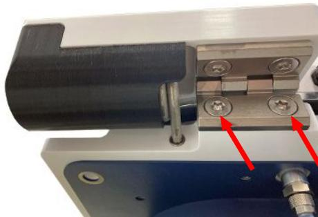
Fig. 14: Fijación en el portamembranas inferior
