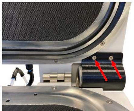
Fig. 13: Resorte en espiral de la cubierta
