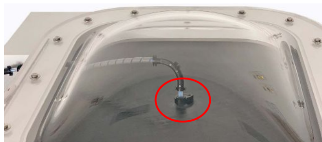
Fig. 6: Abrazadera de trinquete en la parte superior de la cámara de medición
